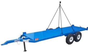
Рис. 13.1 Схема строповки тележки
