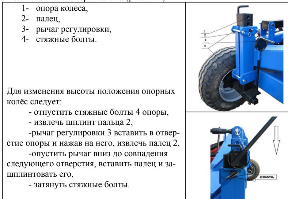
**Опорные колёса не являются элементами регулировки глубины обработки, а служат для мгновенного ограничения повышенной глубины хода рабочих органов в случае колебания трактора на неровностях поля. В этой связи при выбранной глубине обработки положе нижней опорной точки колеса должно находиться на 1-2 см выше поверхности почвы.**
