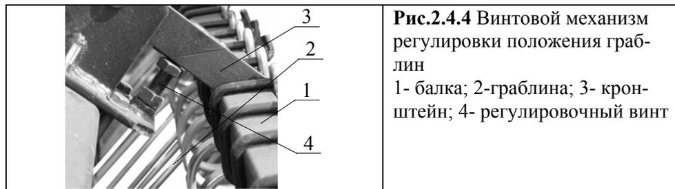
**Рис.2.4.4** Винтовой механизм регулировки положения граблин
