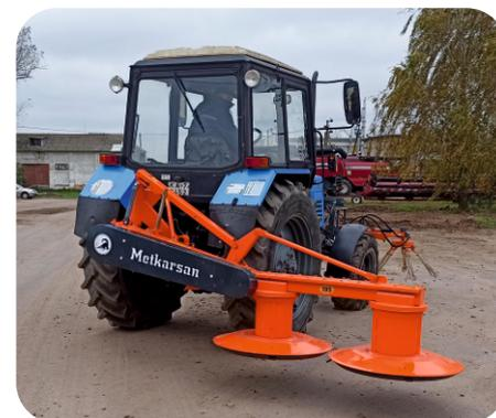
**Под заказ:** косилку можно переоборудовать и дополнить передней навеской для МТЗ-82, благодаря которой на 1 трактор можно навесить 2 косилки и увеличить производительность.
