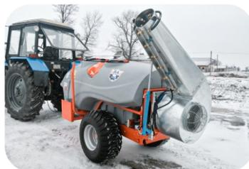
Вентилятор обеспечивает мощный воздушный поток для проведения качественной обработки самых верхних точек кроны.
