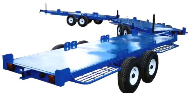
Тандемная ось прицепа в разы повышает его проходимость и плавность хода по пересеченной местности, увеличивает маневренность в узких пространствах сада и плодохранилищ, что позволяет использовать его в составе автопоезда. Конструкция позволила до минимума уменьшить погрузочную высоту прицепа, что позволяет удобно его использовать как при механической, так и при ручной погрузке/разгрузке.
