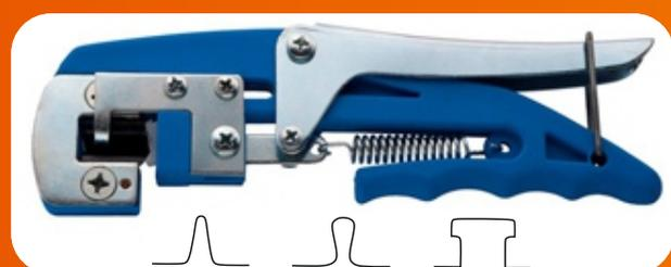
Специальные щипцы для прививки любого типа растений. В комплекте сменная наковаленка и три ножа из прочной высокоуглеродистой закаленной стали — «омега», «клин», «бутон» для настольной и полевой прививки методом окулировки. Ножи легко заменяются. 21 см, 290 г, Ø среза до 10 мм.
